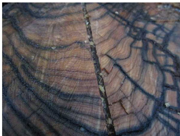
断面（年輪が確認できる。黒い部分は腐朽）
