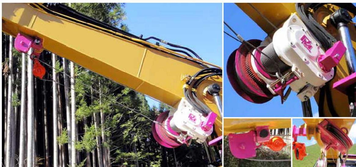
図-3 ウインチ「ウインチロボ」
