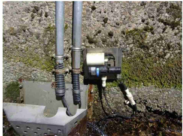
写真-5 濁度計の設置箇所、右の写真は点検のためカバーから濁度計を取出した状態
