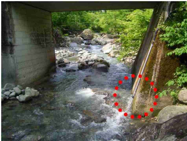
写真-5 濁度計の設置箇所、右の写真は点検のためカバーから濁度計を取出した状態
