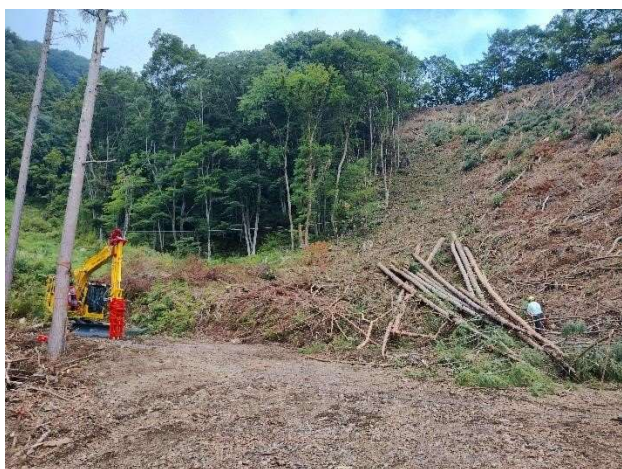
写真－4 1箇所に全幹集材をしている
