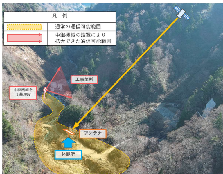
写真－4 低軌道衛星通信の導入概要
