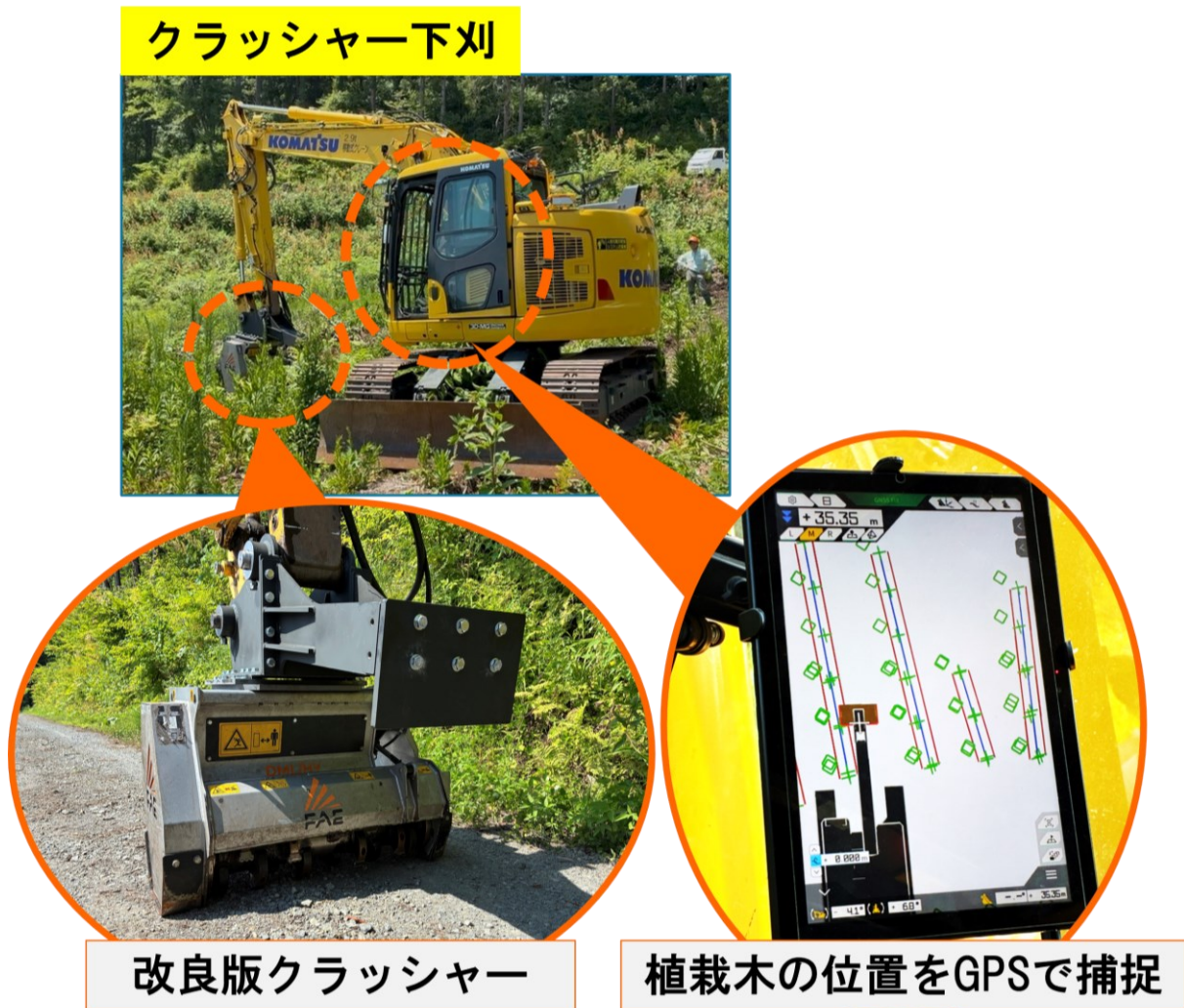
(写真6：ICTを活用した改良版のクラッシャーによる下刈作業)
