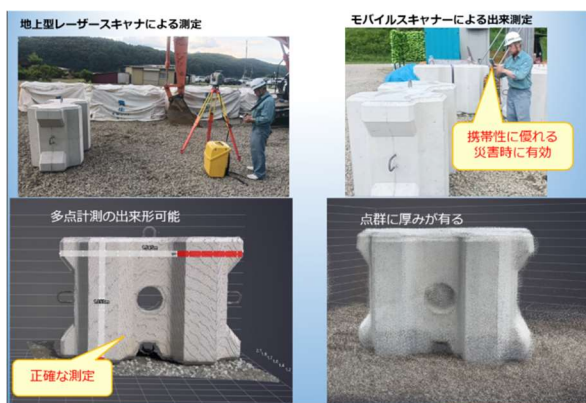
写真-11 スキャナーによる出来形測定
