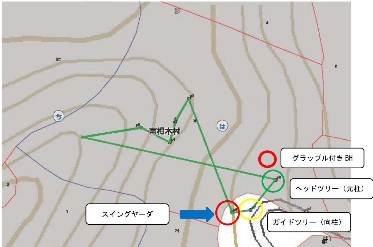
図-2 簡易索張り・スイングヤード・グラップル付きBH関連図
