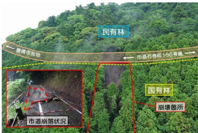
写真－７ 山腹崩壊および市道崩落状況
