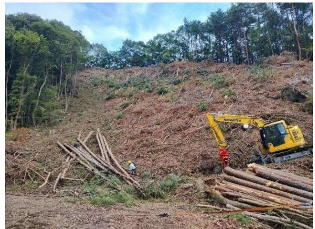
写真-5 グラップル付きBHのオペレーターが荷を外し、スイングヤードのラジコン操作も兼務している
