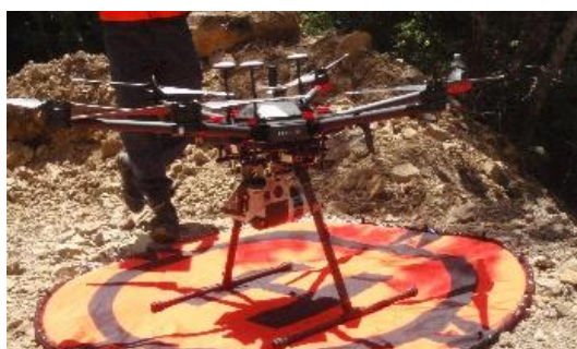
写真-2 無人航空機 (UAV) (DJI 社製)
