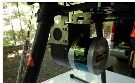
写真-3 レーザースキャナー (YellowScan 社製)
