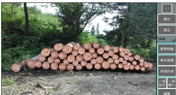
写真6 木材検収システム（タブレット端末での木材検収）
