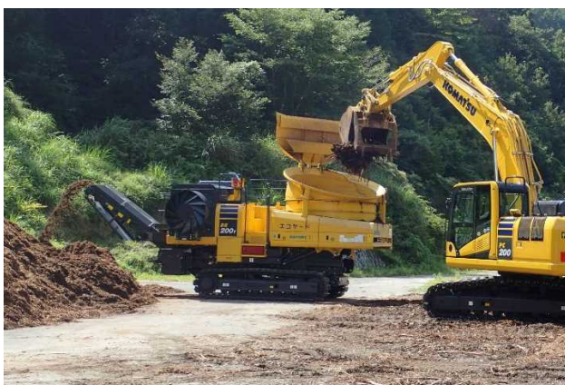
写真一3 タブグラインダーによるチップ化
