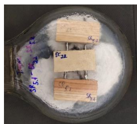
スギ材試験体 試験開始/ RIFI
