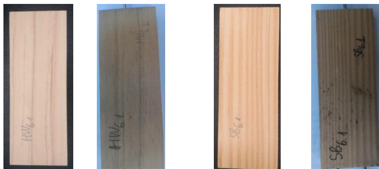
ヒノキ材試験体 試験開始/ RIFI ヒノキ材試験体 6週間後/ RIFI スギ材試験体 試験開始/ RIFI スギ材試験体 6週間後/ RIFI
