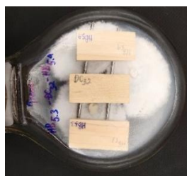
ヒノキ材試験体 試験開始/ RIFI
