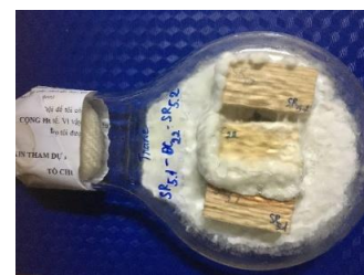
スギ材試験体 6 週間後/ RIFI
