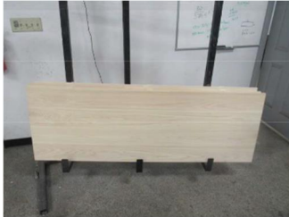
試験パネル養生期間 5日間
