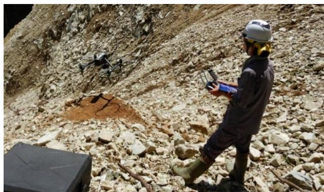
写真－3 UAV 土量計測の様子
