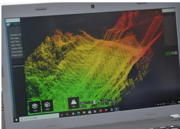
写真-8：点群データによる地形の表示
