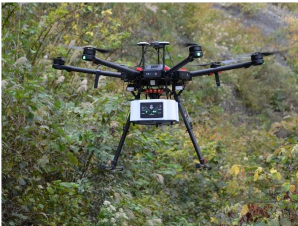
写真-4：ドローン及びレーザースキャナー
