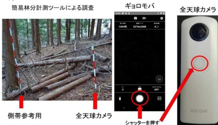
写真－2 簡易林分計測ツールによる現地調査
