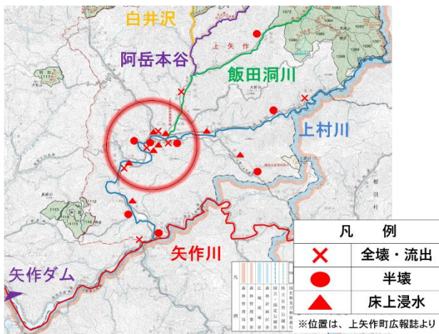
図-4：上矢作町の被災箇所
