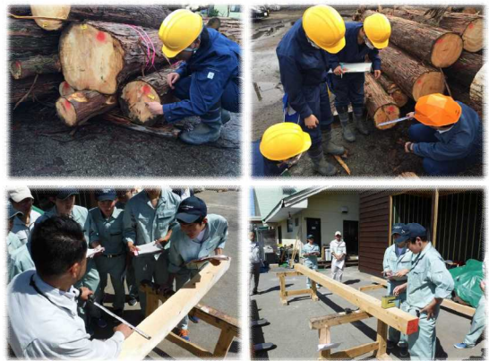
図4：材積計算及び含水率の測定
