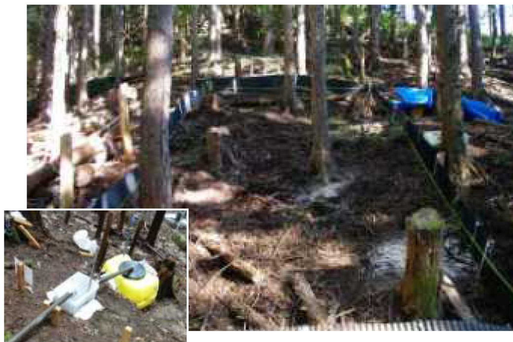
図 5. 地表流観測プロット. 左下の写真は、発生した表面流を貯留するタンク
