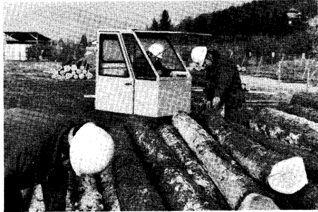
(写真-1) 検知ボックス
