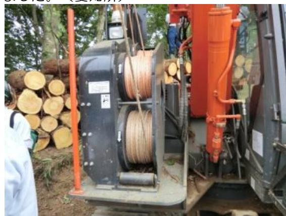
繊維ロープを使用した ウインチ付スイングヤード（愛知所管内）
