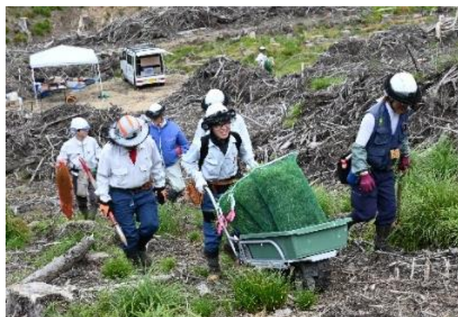
【職員が支える程度で傾斜を登っていく電動式クローラ型一輪車】
