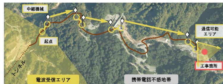
(図1: LTE回線通信仕様の概略図)
