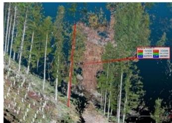
②下刈省略の判定において、雑草木が繁茂する前後の DEM データを用いた試みがされているが、自動飛行を行う際、カメラを真下だけでなく、斜めに向けて撮影することで、DEM データ等の高度の精度が増すと言われています。今回は、約 5m おきに 10 点の斜距離を 3 列、計 30 点実測し、カメラの角度を真下(90°)の他に、最後に斜め写真を加える設定、カメラ角度 70° に傾けた設定、また、撮影高度も 2 通り行いました。各撮影方法にて得られた DEM データから GIS 上で相対座標を求め、斜距離を算出し、撮影方法の組み合わせにより、実測と比較して最も精度の良いものを検証しました。
