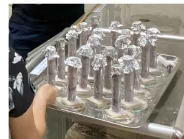
写真2：ベトナムでの取組み TCVN 11355 試験 ヒノキ材試験後の状況 RIFI/ベトナム
