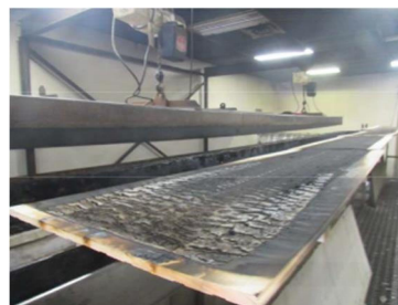
写真1：アメリカの取組み ASTM E84 試験 ヒノキ材試験後の状況 Intertek/アメリカ
