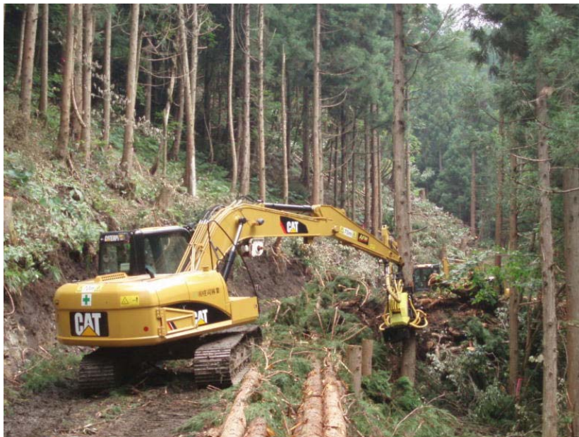
森林作業道と高性能林業機械(ハーベスタ)を活用した 間伐作業 (72林班,(有)庄司林業)
