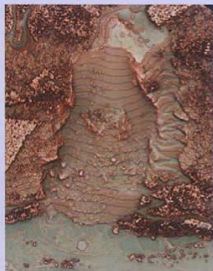
■高梁川崩壊地 レーザーによる0.5m DSM 崩壊地内部の礫の形状までわかります。
