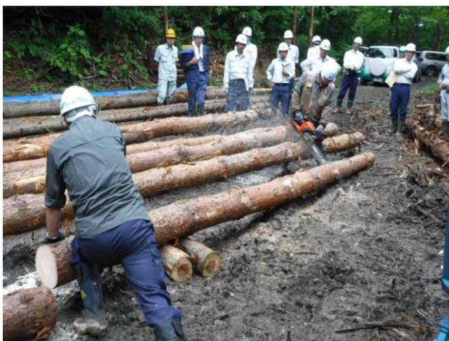
盛岡森林管理署としては4m材を多く採材し、長材比率を向上させ一般用材の割合を増やすことで経済的価値を高めていきたい考えていますが、材の形質（曲がり、節等）を適切に判断して採材を行うことが重要であることを再認識しました。
