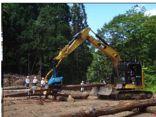
曲り材の玉切り状況
