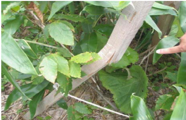
写真-10 ヒバ支柱折損箇所
