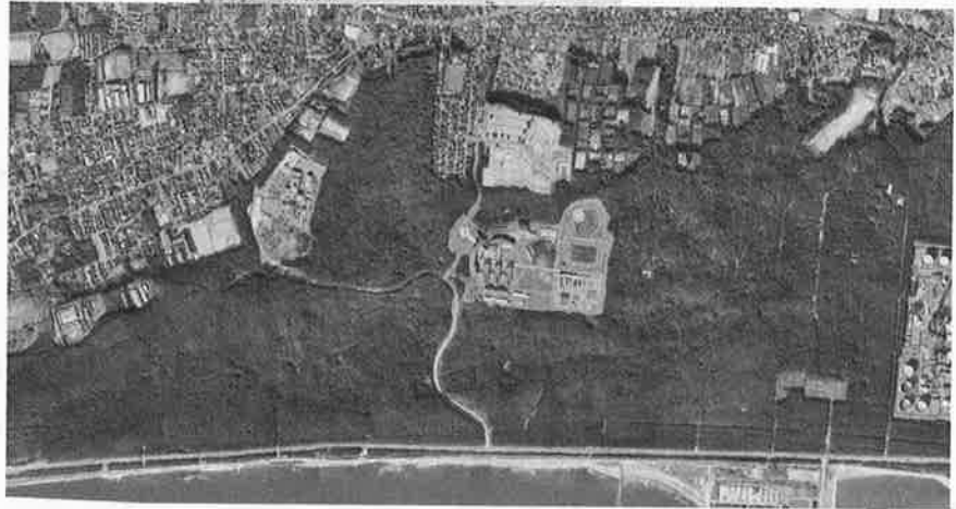
3飛行コース、合計33枚のオルソ画像をモザイクした集成画像
