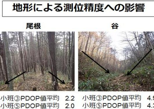
図-5 地形による測位精度への影響
