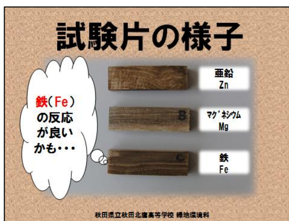
Fig8 煮沸試験其の2の実験後の様子
