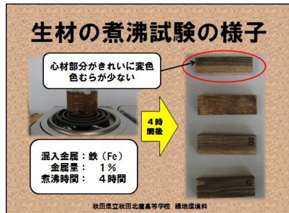
Fig10 煮沸試験其の 3 の試験の様子
