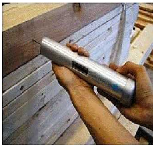
図10 木材腐朽試験機（ピロデイン）
