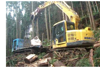
トンバッグを用いた搬出実証 (米代東部署)
