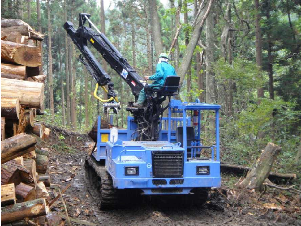
フォワーダによる巻立て状況
