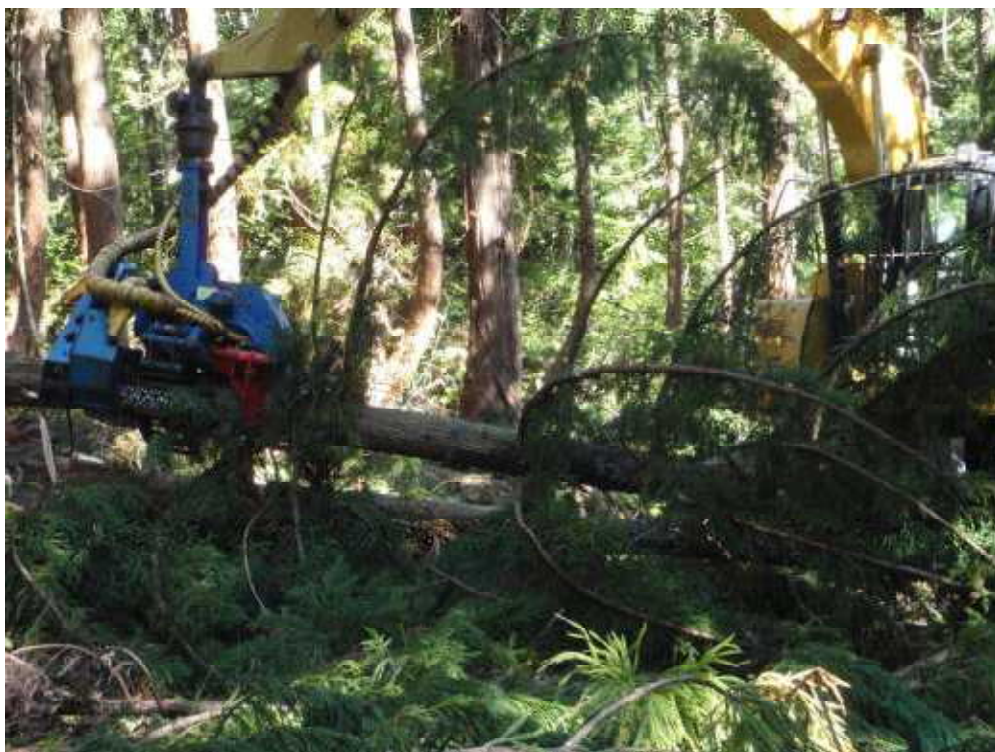
高性能林業機械 (ハーベスタ) による作業状況
