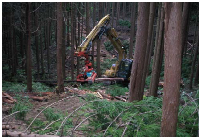
高性能林業機械による枝払い・玉切り作業（宮城県仙台市（仙台署））
