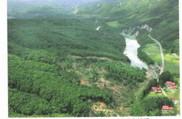
磐井川 地すべり末端部の河道閉塞状況
