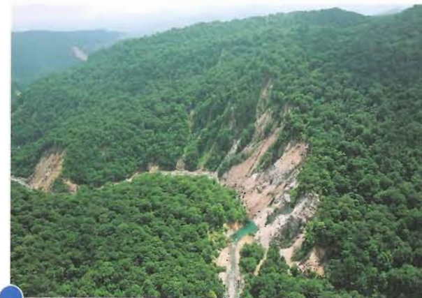
尿前沢最上流部 山腹崩壊による河道閉塞状況
