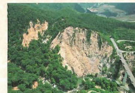
岩盤崩壊 胆沢川流域
