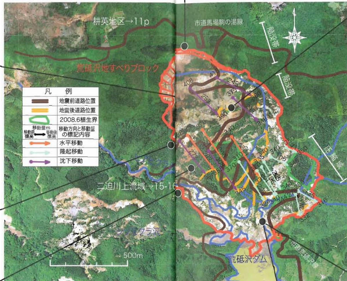
荒砥沢地すべり周辺のオルソ画像(朝日航洋株式会社撮影) 地震前後の空中写真から推定される地すべりの移動方向
