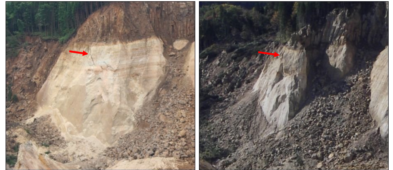
図 1.2.12 滑落崖右側の亀裂の状況(左: 2008年6月23日 右: 2009年10月15日)
