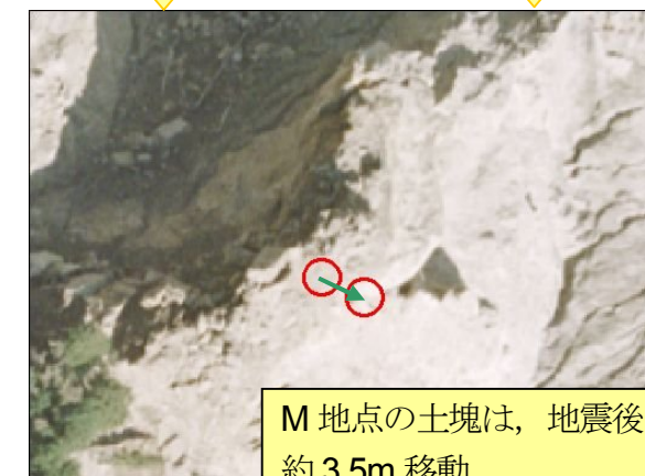
図 1.2.13 オルソ画像による右側壁側土塊の移動(左: 2008年6月 DMC 右: 2009年10月 RC30)
