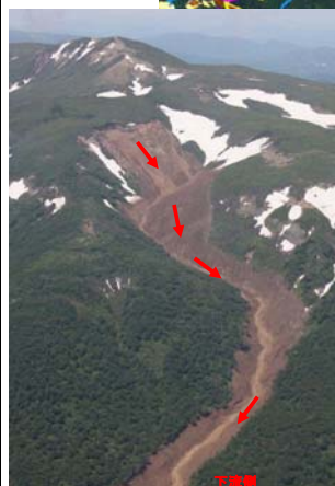
ドソウ沢源頭部の崩壊と土石流の流過痕跡
