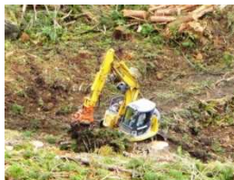
伐採・搬出中に集材で用いたグラップル等で地拵を行う。
