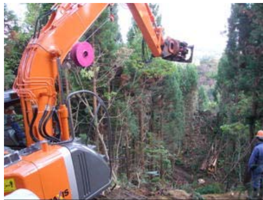
列状間伐のスイングヤード集材の様子 (山形県(最上支署))
