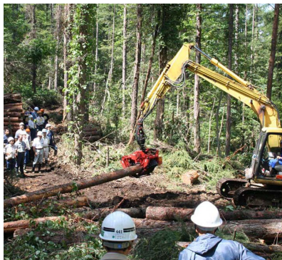
ウインチ付プロセッサーによる集造材作業
