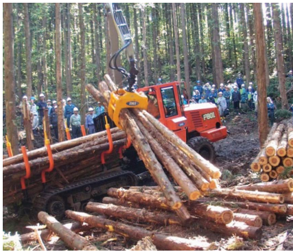
新型フォワーダによる集材作業
