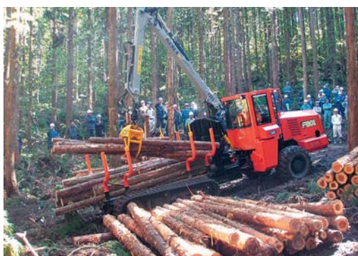
新型フォワーダ「F801」による運材作業
