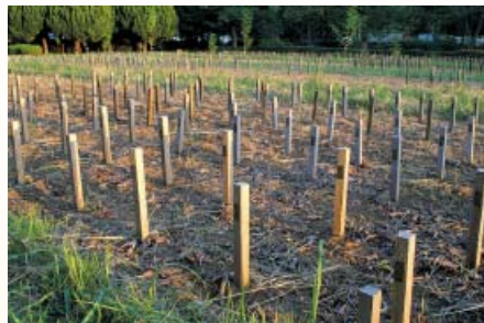
写真1 木材の耐久性を調べる野外杭試験場
