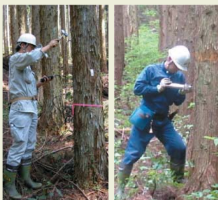
写真 ファコップ（左）とピロディン（右）の測定の様子
