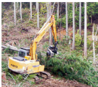
高性能林業機械（プロセッサ）による造材作業
