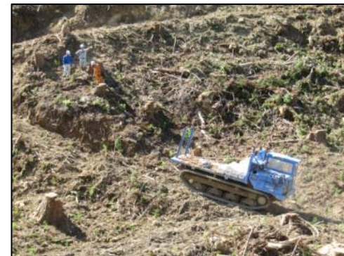
丸太運搬後、コンテナ苗木の運搬に同じ運搬車を活用
