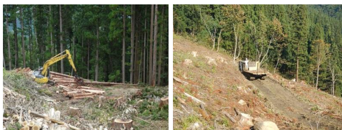
一貫作業システム（伐採 ⇒ 丸太運搬 ⇒ コンテナ苗運搬） (写真左) 高性能林業機械による造材の様子 (写真右) コンテナ苗運搬の様子
