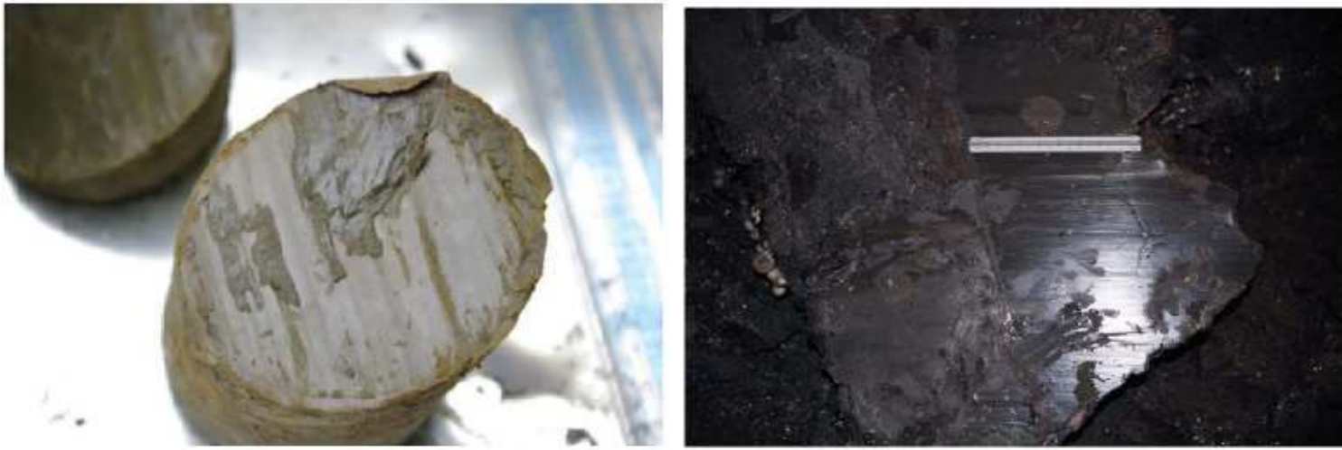
図 3. 2.4 すべり面，左は S-5（ボーリングコア），右はトンネル脱出口掘削時の採取された試料
