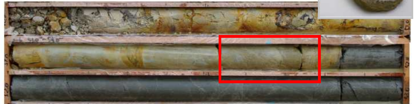
図 5. 3. 28 コア試料 (S-6 : GL-50.0~53.0m) とせん断面 (GL-51.75m)
