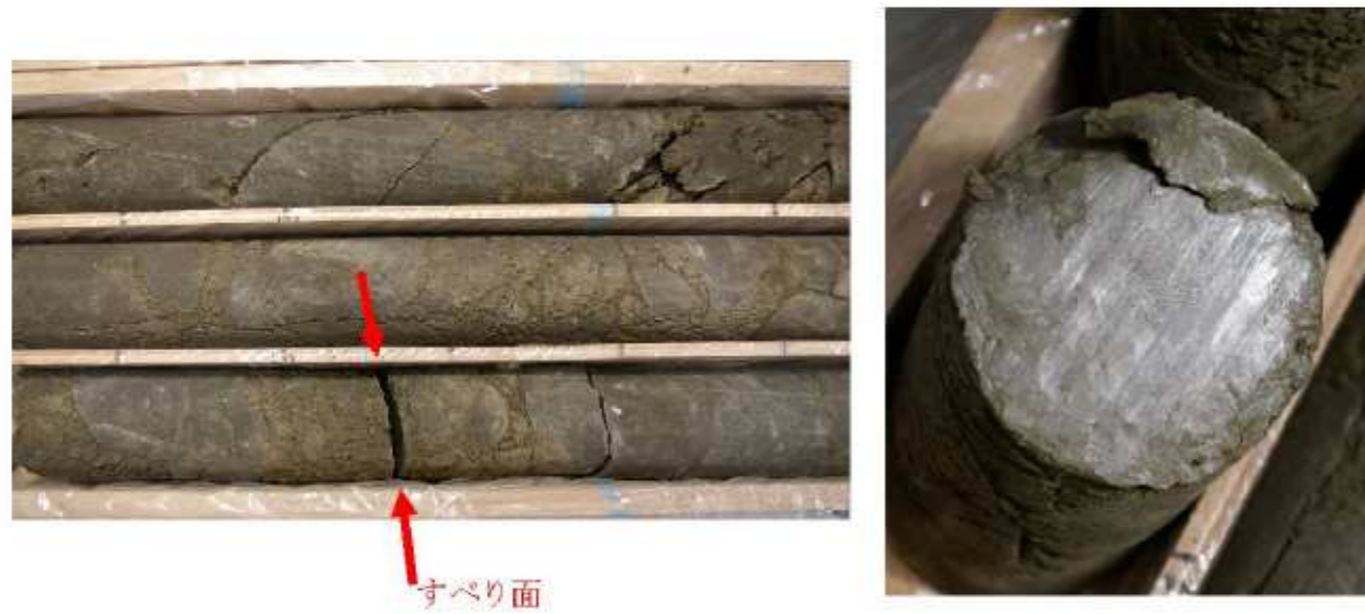
図 5. 3.4 ボーリングコアで採取された泥岩上面のすべり面 (S-1 主すべり面)
