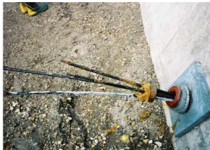
写真 ⑥ 地すべり末端部で破壊されたアンカー tendon
